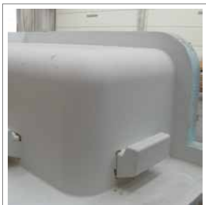
Fig.11: Stampo ottenuto per Direct Moulding
