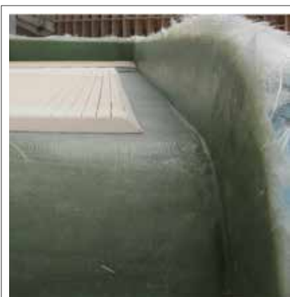
Fig.12: Stratificazione hand lay-up
